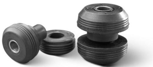
Les supports antivibratoires AMC-Mecanocaucho® type SCH sont formés de deux pièces en caoutchouc, l'une portant une douille métallique intérieure qui sert de guide à travers la vis de fixation au support de la machine. On le monte précomprimé à même le châssis de la machine; l'épaisseur "T" détermine le degré de précompression du support.
