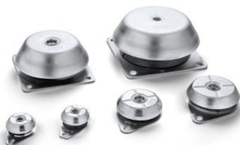
Les supports de cloche BRB Amc-Mecanocaucho® sont des antivibratoires qui travaillent l'élastomère en compression-cisaillement. Disposent d'une hauteur supérieure et fournissent grâce à cela une élasticité accrue et une fréquence propre plus basse. Cette gamme de supports est idéale pour les applications où l'isolation vibratoire est prioritaire.
