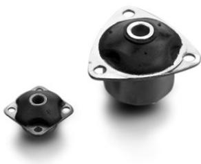
Le support antivibratoire A.T. est spécialement conçu pour l'isolation de moyennes et hautes fréquences. Il est constitué d'une douille en caoutchouc montée entre deux armatures tubulaires concentriques. L'armature intérieure est un tube cylindrique. L'armature extérieure est également tubulaire, avec une bride qui peut recevoir les trous de fixation.
